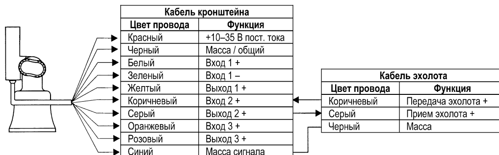
Рис. 4.7. Подключение эхолота к картплоттеру с быстросъемным кронштейном
