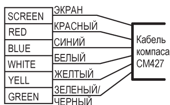
Рис. 3.4. Подключение кабеля индукционного компаса к разъему
