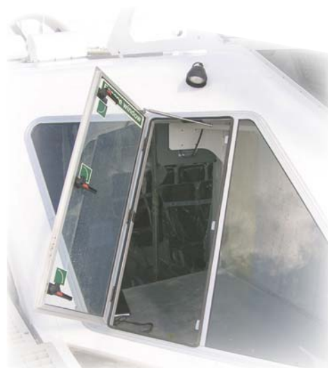
Дверь аварийного выхода с боковыми петлями
